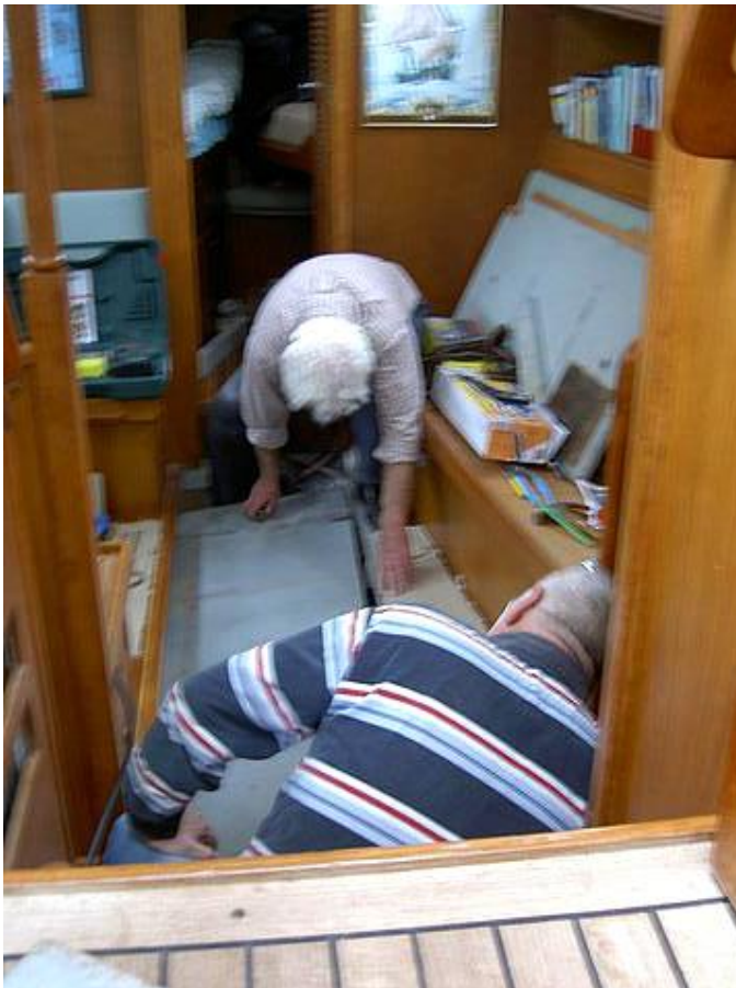
Foto 3. En nu moet hij eruit. Doet'ie het, of doet'ie het niet. Een inspannende klus, omdat het hier en daar klem loopt en de tank glad is en dus vrijwel geen houvast biedt.
