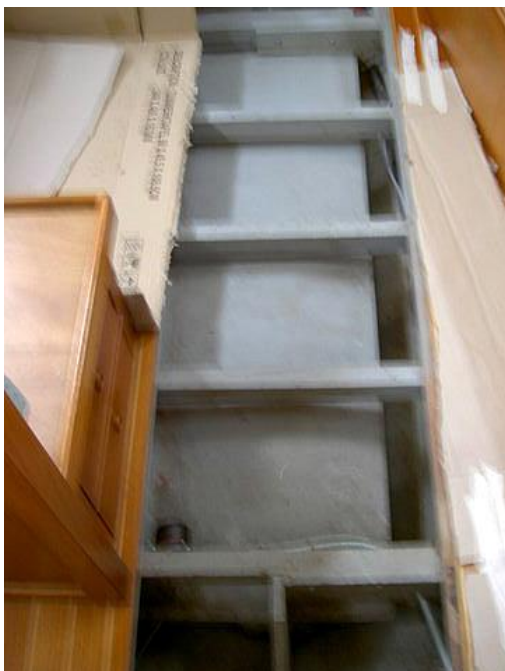
Foto 1 laat zien hoe de tank in de oorspronkelijke staat onder een zestal vloerspanten ligt.
