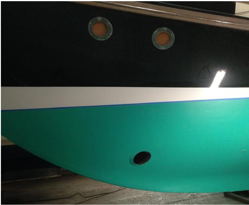
Mooi strak resultaat na het aanbrengen van de epoxycoating.
