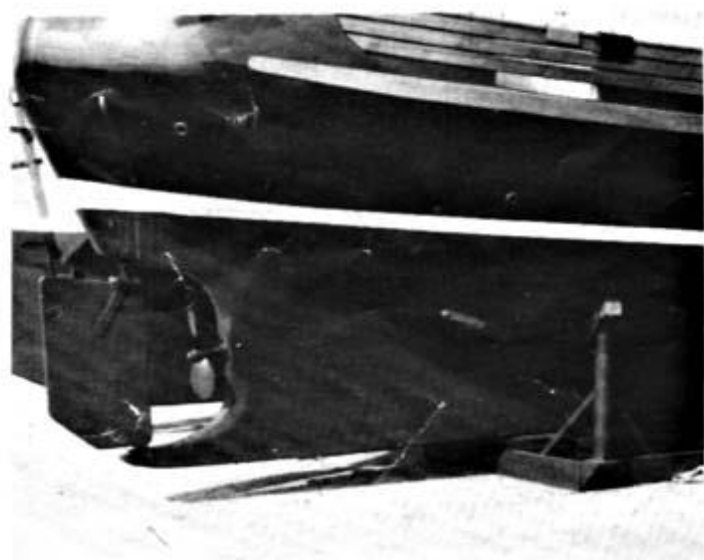
Slank spitsgatachterschip met tweebled schroef
