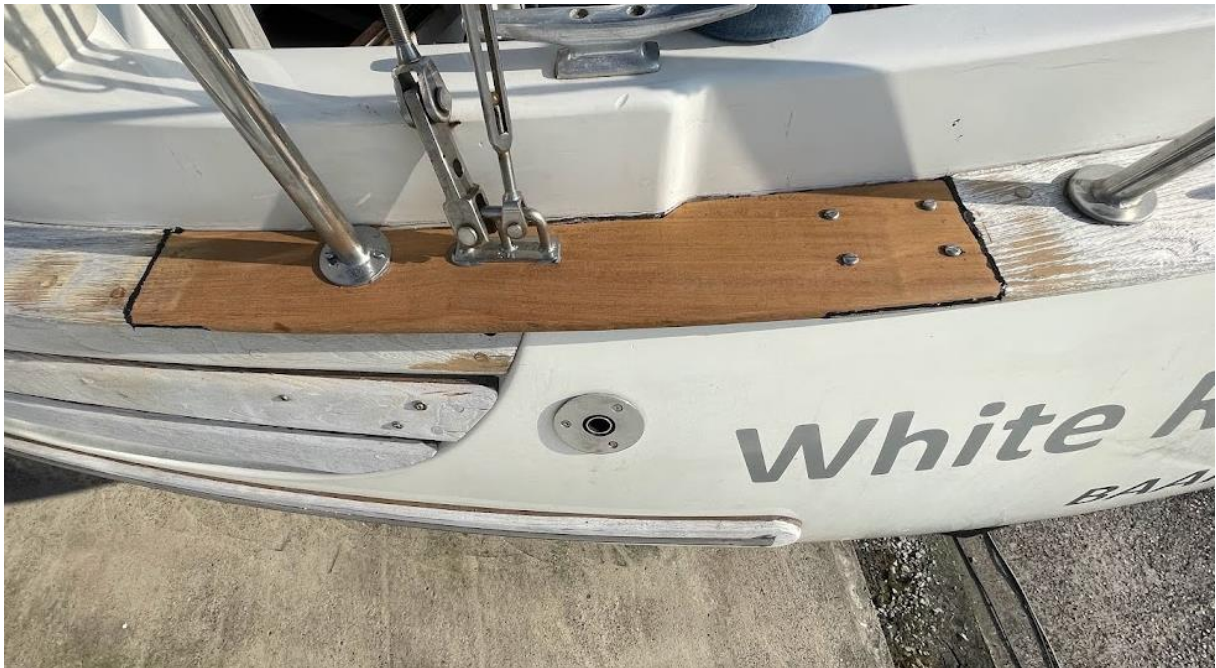
Nieuwe deel zit op zijn plek en is op maat gemaakt, nu nog het kitwerk tegen de opstaande rand
