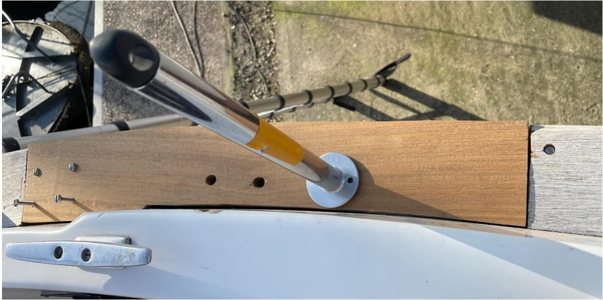
Het passen en meten is het belangrijkste, hier staat de scepter nog los
