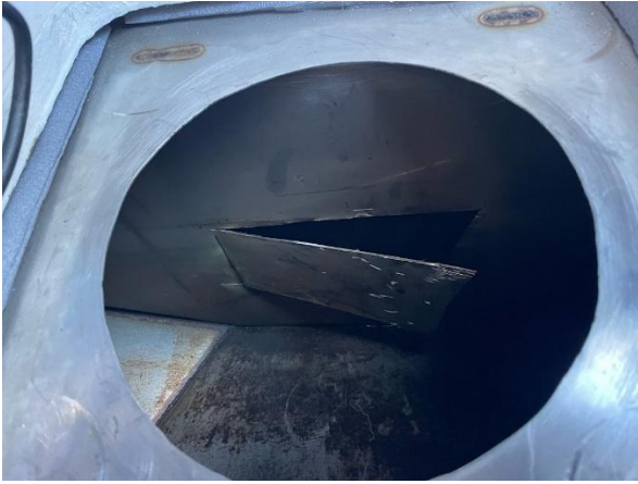
In het schommelschot komt een opening.
