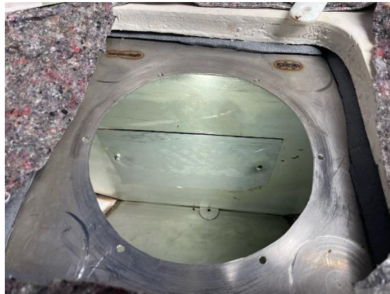
Zicht op het nieuwe afdekschotje in het schommelschot.
